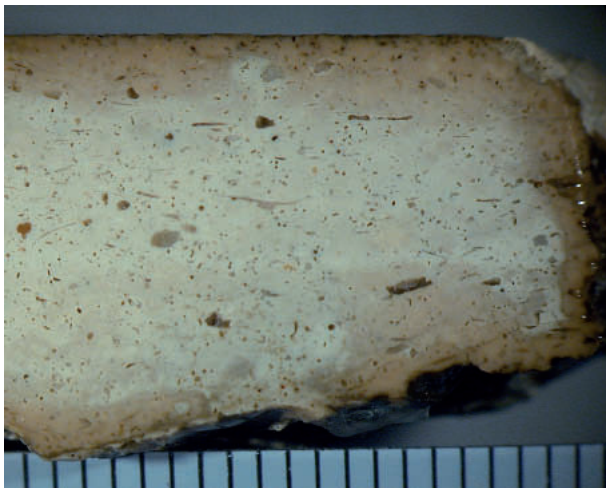
Abb. 5 eingewanderte rötlich-bräunliche Ton- und Eisenbestandteile in Randbereichen AS (P. 020)
