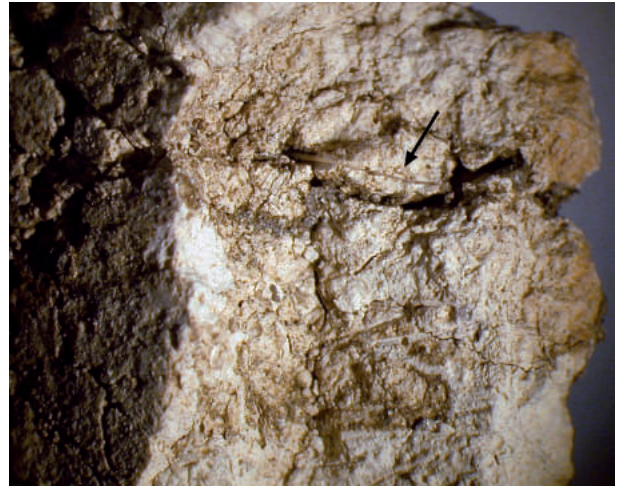
Abb. 10 im Putzgefüge eines Estriches erhaltene organi- sche Faser, Bildbr. 1cm (P. 004)
