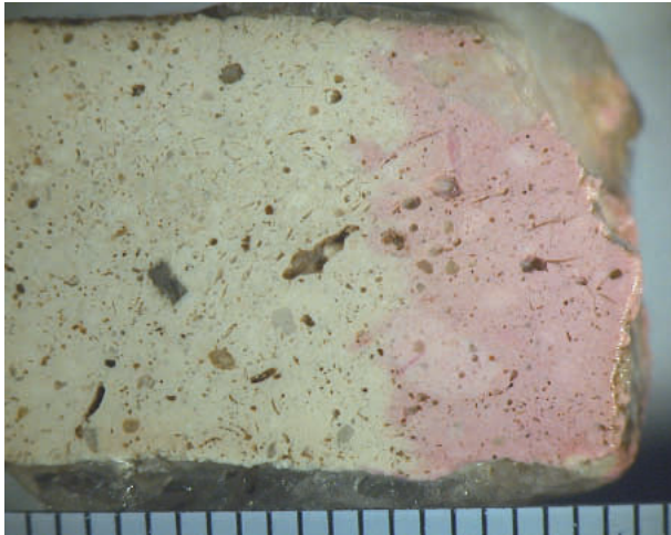
Abb. 3 Anfärbung auf Calcit, die rote Färbung belegt Kalk als Bindemittel und calcitische Partikel, Anschliff (P. 001)
