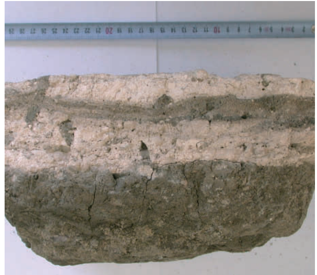
Abb. 16 Inhalt eines Mörtel-Beckens: wechselnde Schichtung aus lehmigem Erdmaterial und Brandkalkkonglomerat (P. 024)
